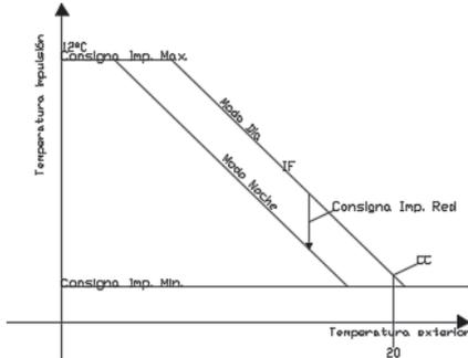
CC=0 asigna una impulsión de 20°C para temperatura exterior de 20°C
