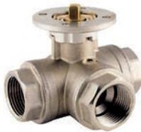
Posee una esfera perforada en T que permite el paso recto del caudal entre B y C, o bien el desvío del caudal entrante por una de las vías laterales B o C hacia la vía central A. (Ver Fig 1- 2 y 3-4).
