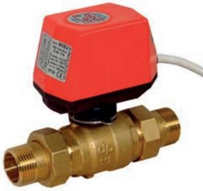
Válvulas de 2 vías con obturador de esfera con paso total, accionadas por un servomotor eléctrico de rotación unidireccional, que se acopla al cuerpo de válvula mediante un sencillo sistema de montaje rápido.
