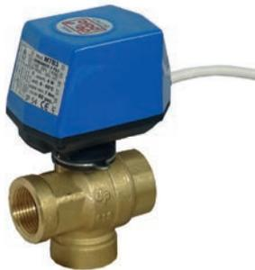
Válvulas de 3 vías con un obturador de esfera que está perforado según la hidráulica que resuelven. Se motorizan con un servomotor eléctrico, que se acopla al cuerpo de válvula mediante un sencillo sistema de montaje rápido.
