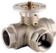
Posee una esfera perforada en L que permite el desvío del caudal de la vía A central a las laterales B y C **aislando hidráulicamente ambos circuitos (ver Fig.1 y Fig.2)**. El servomotor se acopla sobre el cuerpo de válvula con una conexión tipo ISO 5211 existiendo versiones para el control a 2 o 3 puntos, con contacto auxiliar incorporado. La elección de la posición de apertura se realiza gracias a la indicación, sobre el eje de la válvula, de la posición de las vías.
