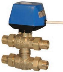
Válvulas de 4 vías con un obturador de esfera perforado para crear un by-pass entre la impulsión y el retorno. Se motorizan con un servomotor eléctrico, que se acopla al cuerpo de válvula mediante un sencillo sistema de montaje rápido.
