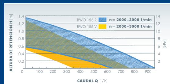
La velocidad se puede ajustar en función de los requerimientos de la instalación.
