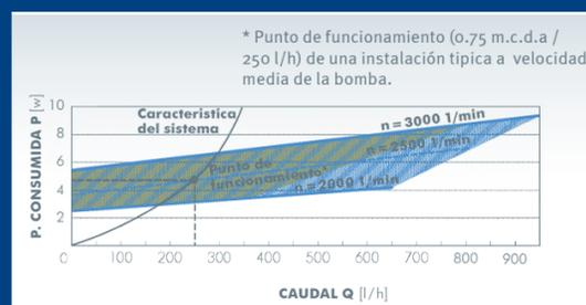
Dada una instalación estándar y utilizando el ajuste de fábrica de la velocidad de 2500 1/min, el consumo de la bomba es aproximadamente 5W.
