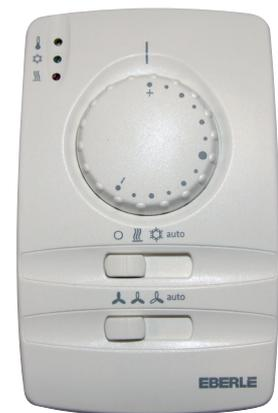
Permite la conexión de una sonda remota en retorno (SN 8PCL1500), y de una sonda de temperatura de agua (SN PAA1500) que retarda la conexión del ventilador en función de la temperatura del agua en la tubería.
