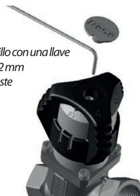
Apretar el tornillo con una llave hexagonal de 2mm para fijar el ajuste de caudal.
