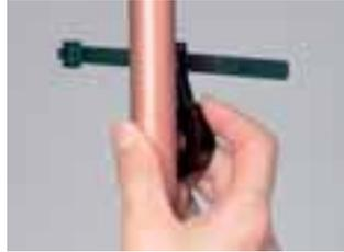
Desenrolle el cable del sensor y sujete el sensor acoplado de temperatura en el sistema de entrada.
